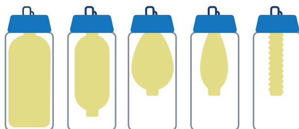
FIGURE 1. Représentation d'une pompe élastomérique administrant un médicament au fil du temps.
